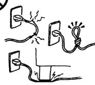
Beschadig of wijzig de netsnoeren niet. Plaats geen zware voorwerpen op de snoeren, trek er niet aan en knik de snoeren niet. Dit alles kan aanleiding geven tot elektrische schokken en brand.
