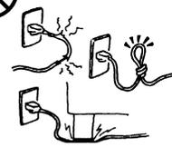
Die Netzkabel dürfen nicht verkratzt, beschädigt oder verändert werden. Außerdem dürfen sie nicht durch schwere Gegenstände belastet, gezogen oder geknickt werden, weil dadurch **Feuer** oder **elektrische Schläge** verursacht werden können.
