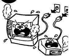
Une utilisation prolongée de l'imprimante dans une condition anormale, comme par exemple lorsque l'imprimante produit de la fumée ou des odeurs étranges peut être source d'**incendie** ou de **choc électrique**. Dans ce cas, mettez immédiatement l'interrupteur marche/arrêt sur Arrêt et déconnectez le câble secteur de la prise murale. Ensuite, contactez votre revendeur agréé TOSHIBA TEC CORPORATION pour une assistance technique.
