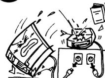
Falls die Maschinen fallengelassen oder ihre Gehäuse beschädigt werden, schalten Sie zuerst die Netzschalter aus, und ziehen Sie die Netzstecker von den Steckdosen ab, bevor Sie sich an Ihren örtlichen TOSHIBA TEC CORPORATION Fachhändler wenden. Fortgesetzter Betrieb der Maschine unter dieser Bedingung kann zu **Feuer** oder **elektrischen Schlägen** führen.
