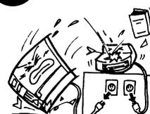
Se os equipamentos forem derrubados ou danificados, primeiro desligue e retire a ficha da tomada eléctrica, e depois contacte o seu representante oficial TOSHIBA TEC CORPORATION para o assistir. O uso continuado do equipamento naquelas condições pode causar **incêndio** ou **choques eléctricos**.
