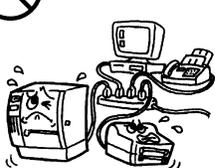
Het aansluiten van verschillende toestellen met een hoog elektrisch verbruik op éénzelfde voeding kan leiden tot spanningsverschillen en bijgevolg een slechte werking van de toestellen. Gebruik dus een afzonderlijk stopcontact voor elk toestel, zoniet is er gevaar voor **brand** en **elektrische schokken**.
