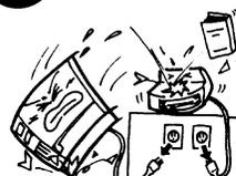
В случае падения аппарата или повреждения корпуса, выключите аппарат и отсоедините вилку кабеля питания от розетки, а затем обратитесь к представителю компании TOSHIBA TEC CORPORATION. Продолжение использования поврежденной машины может привести к **пожару** или поражению **электрическим током**.
