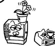
Не ставьте металлические предметы или ёмкости с водой (вазы, горшки с цветами, чашки и пр.) на аппарат. Если металлический предмет или жидкость попадет внутрь аппарата, то возможен **пожар** или **удар током**.
