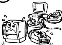
Se os equipamentos partilharem a mesma tomada com qualquer outro equipamento eléctrico que consuma grande quantidade de electricidade, a voltagem flutuará cada vez que estes equipamentos entrem em funcionamento. Esteja certo de usar uma só tomada exclusiva para o equipamento evitando com isto riscos de **incêndio** ou **choque eléctrico**.
