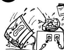
Si la machine tombe, ou si son capot est endommagé, commencez par mettre le bouton marche/arrêt sur arrêt et par débrancher le câble secteur de la prise murale. Ensuite, contactez votre revendeur agréé TOSHIBA TEC CORPORATION pour une assistance technique. Une utilisation prolongée de l'imprimante dans ces conditions peut être source d'**incendie** ou de **choc électrique**.
