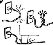
Não arranhe, danifique ou modifique os fios eléctricos. Também não coloque objectos pesados em cima, não puxe, ou dobre excessivamente os fios eléctricos, pois com isto pode causar **incêndios** ou **choques eléctricos**.
