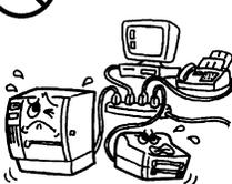
Si la machine partage une même prise avec d'autres appareils consommant beaucoup d'électricité, il y aura des fluctuations de tension importantes lorsque ces appareils fonctionnent. Pour éviter tout risque d'**incendie** ou de **choc électrique**, ne branchez pas d'autres appareils à la même prise que la machine.
