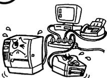
Если аппарат подключен к розетке, к которой уже подключено несколько приборов, потребляющих большое количество энергии, то в сети возможны значительные перепады напряжения, каждый раз, когда устройства начинают работать. Убедитесь, что аппарат подключен к выделенной розетке, во избежание **пожара** или **удара током**.
