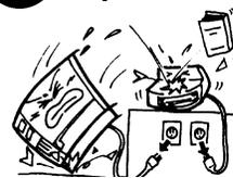
Zet het toestel af en haal vervolgens de stekker uit het stopcontact indien het toestel is gevallen of de behuizingen beschadigd zijn en stel u in verbinding met een erkende TOSHIBA TEC CORPORATION verdeler voor bijstand. Het gebruik van het toestel onder deze omstandigheden kan aanleiding geven tot **brand** of **elektrische schokken**.
