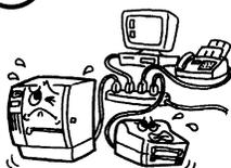
Falls die Maschinen dieselbe Stromquelle mit irgendwelchen anderen Elektrogeräten teilen, die einen hohen Stromverbrauch haben, kann es zu Spannungsschwankungen kommen, wenn diese Geräte in Betrieb genommen werden. Schließen Sie die Maschinen unbedingt an, da es unter Umständen zu einem **Kurzschluß** oder **Überlastungen** führen kann, die dann einen Brand auslösen können.
